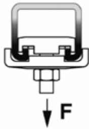
Max. zulässige Punkttragfähigkeit F_{max}
